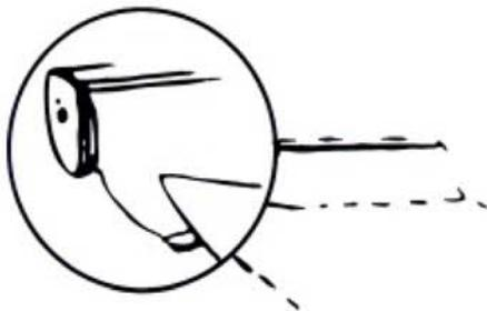
5. Presiona la imagen firmemente contra el tubo (con la izquierda) y saca la clavija de seguridad. ¡OJO! ahora el mecanismo está activado.
